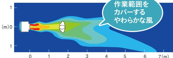
(条件) 冷房運転、強風量、60Hz ※直吹き風量時の分布図です
